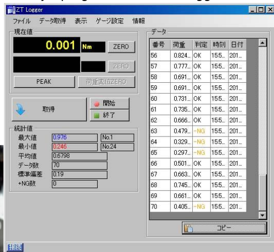
Pomiar momentu siły przełącznika obrotowego
